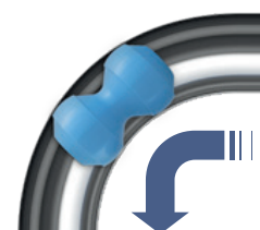
Molchen von DIN-Bögen ohne Produktvermischung
