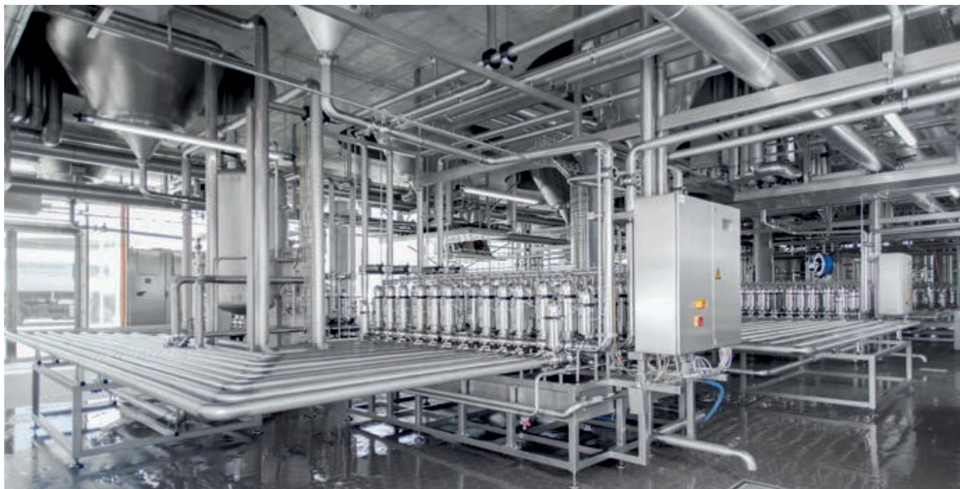
4.000 Meter Trägerrohr und 5.400 Meter Getränkeleitungsrohr (davon 900 Meter vorisoliert) für einen hochmodernen Gär- und Lagerkeller
