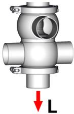
Das Ventil öffnet von oben nach unten mit Steuerluft und schließt von unten nach oben mit Federkraft produktverlustfrei. In der Zustellung wird der obere und untere Ventilgehäuseraum, bei durchfließenden unterschiedlichen Medien, durch zwei unabhängig geschlossene Ventilteller leakagesicher getrennt. Auftretende Leckagen, bedingt durch beschädigte Ventiltellerdichtungen, werden drucklos über den Leckageablauf (L) ins Freie abgeführt.
